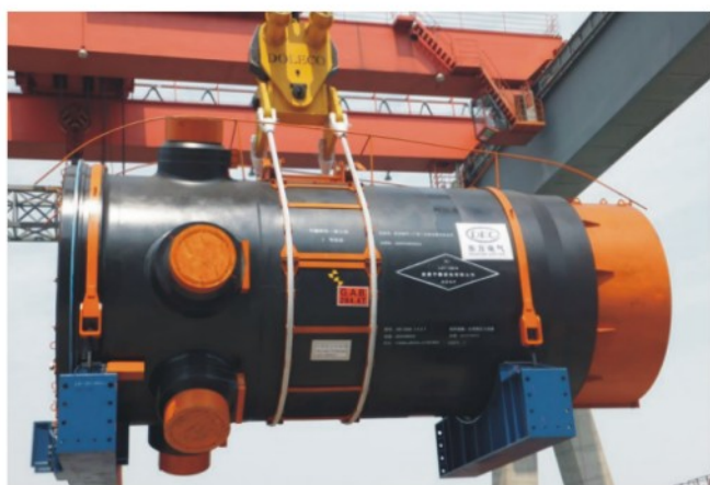
宁德反应堆压力容器发运
