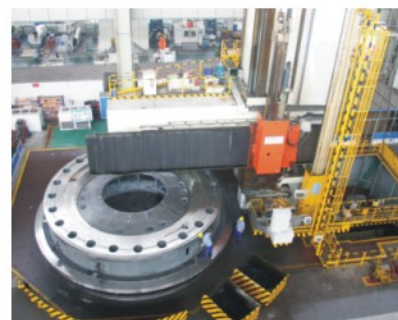
溪洛渡770MW水轮机顶盖加工
